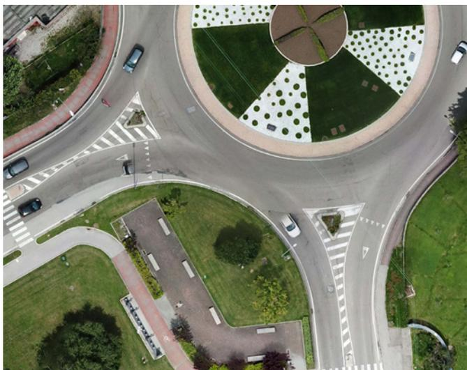
**Ortofoto** ad alta risoluzione (fino a oltre 1 cm/pixel) topograficamente corrette<sup>1</sup> e georeferenziate di aree fino anche a 20 ettari.
