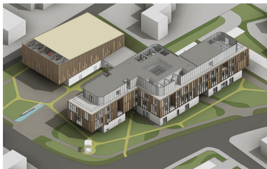
Vista assonometrica del modello BIM sviluppato per la fase costruttiva. Il complesso è articolato in tre volumi principali: la nuova sede municipale, un teatro comunale e una caffetteria con funzione di connessione tra gli edifici.
